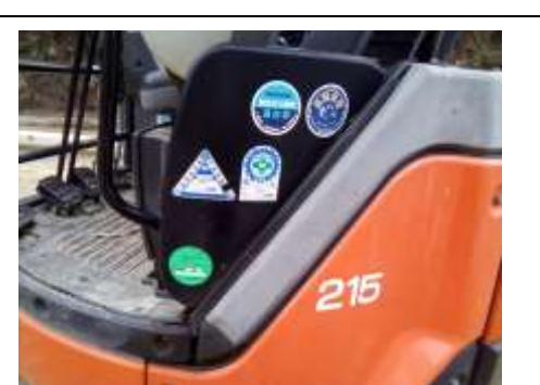
写真-8 排出対策型重機
