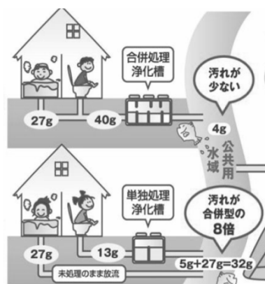
合併処理浄化槽と単独処理浄化槽によるBOD(水質を汚濁させる汚れ分)排出量(g)の比較
