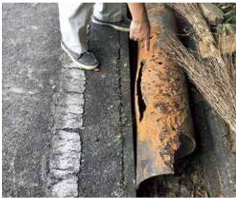
長岡断水事故の破断管(S48敷設)の状態
