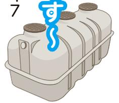
浄化槽は、微生物の働きを利用して、汚水をきれいにする装置です。
