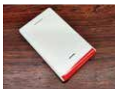
端子部分や接続部分 をテープで絶縁
