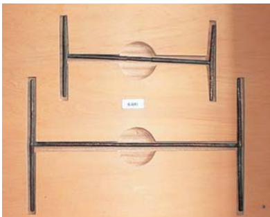
「柁」かせ。ねじり合わせた繊維を巻き取るときに使用します。「工」の字の形をしています
