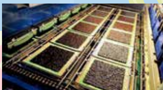
定量定型に自動調整されノリ乾燥機にコンベヤーで入っていく直前のノリ。できあがったものが「乾ノリ」である。
