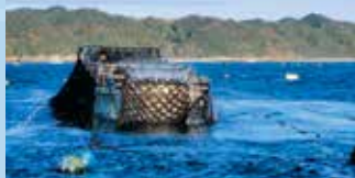
沖合にある「浮き流し式」。ノリ網の下をくぐるようにしてノリを刈り取るノリ収穫専用船。通称「潜り船」。
